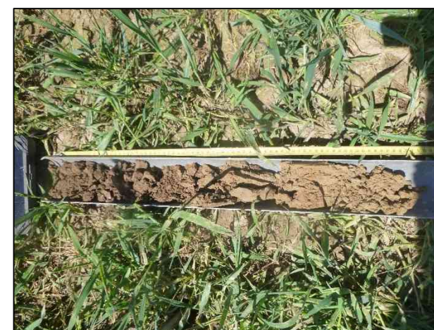
Figure 33 : Sondage n°8 caractéristique de zones humides (traces d'oxydation avant 25 cm et s'accroissant en profondeur)
