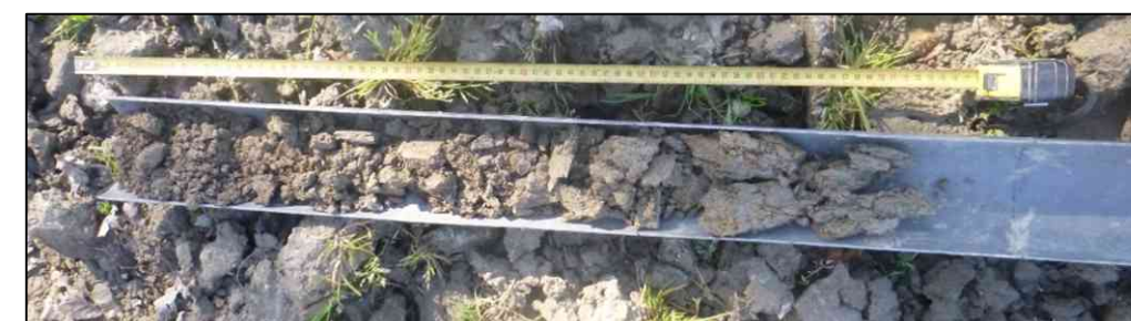
Figure 33 : Sondage n°8 caractéristique de zones humides (traces d'oxydation avant 25 cm et s'accroissant en profondeur)
