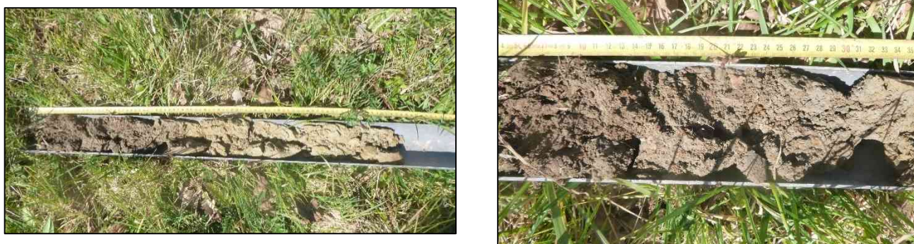
Figure 35 : Sondage n°25, caractéristique de zones humides (traces d'oxydation avant 25 cm et s'accroissant en profondeur)
