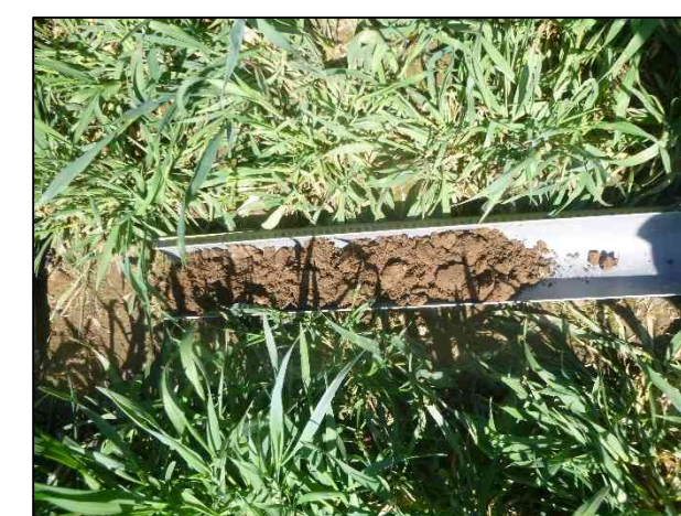
Figure 33 : Sondage n°8 caractéristique de zones humides (traces d'oxydation avant 25 cm et s'accroissant en profondeur)
