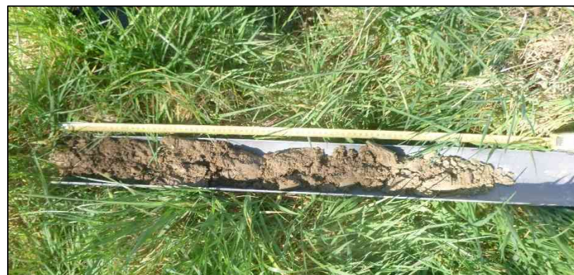
Figure 35 : Sondage n°25, caractéristique de zones humides (traces d'oxydation avant 25 cm et s'accroissant en profondeur)
